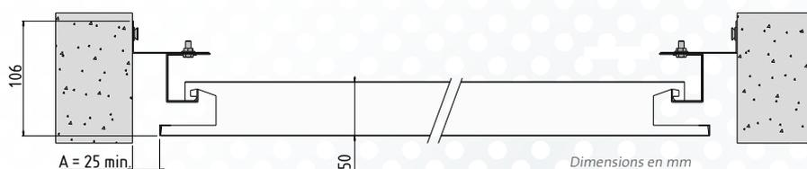
Un écart A est nécessaire entre le bac et le mur
