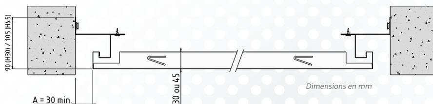
Un écart A est nécessaire entre le bac et le mur
